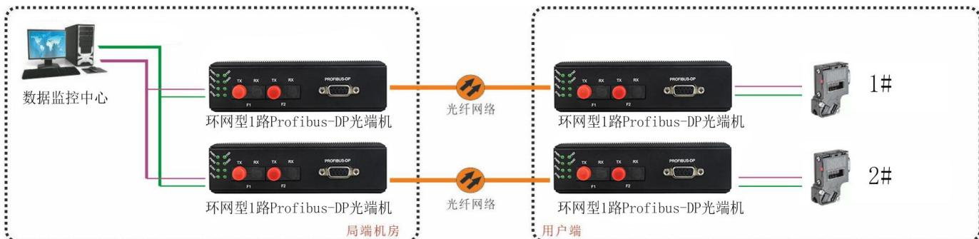
**链型 (Line)** 应用场合：多个总线节点间需要远距离通讯，或者多个节点间需要完全的电气隔离抗干扰
